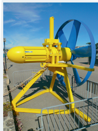
Photo d'une hydrolienne D03, construite par l'entreprise Sabella, exposée à Port Navalo en mai 2017 Crédit : Wikimedia / Rundvald
