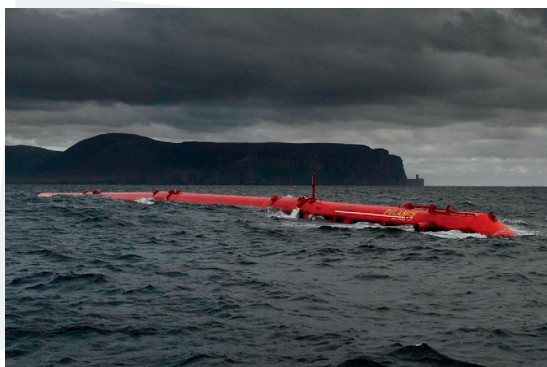
Photo d'une chaîne flottante articulée au large de l'Écosse, 2008, modèle «Pelamis». Crédit : Wikipédia
